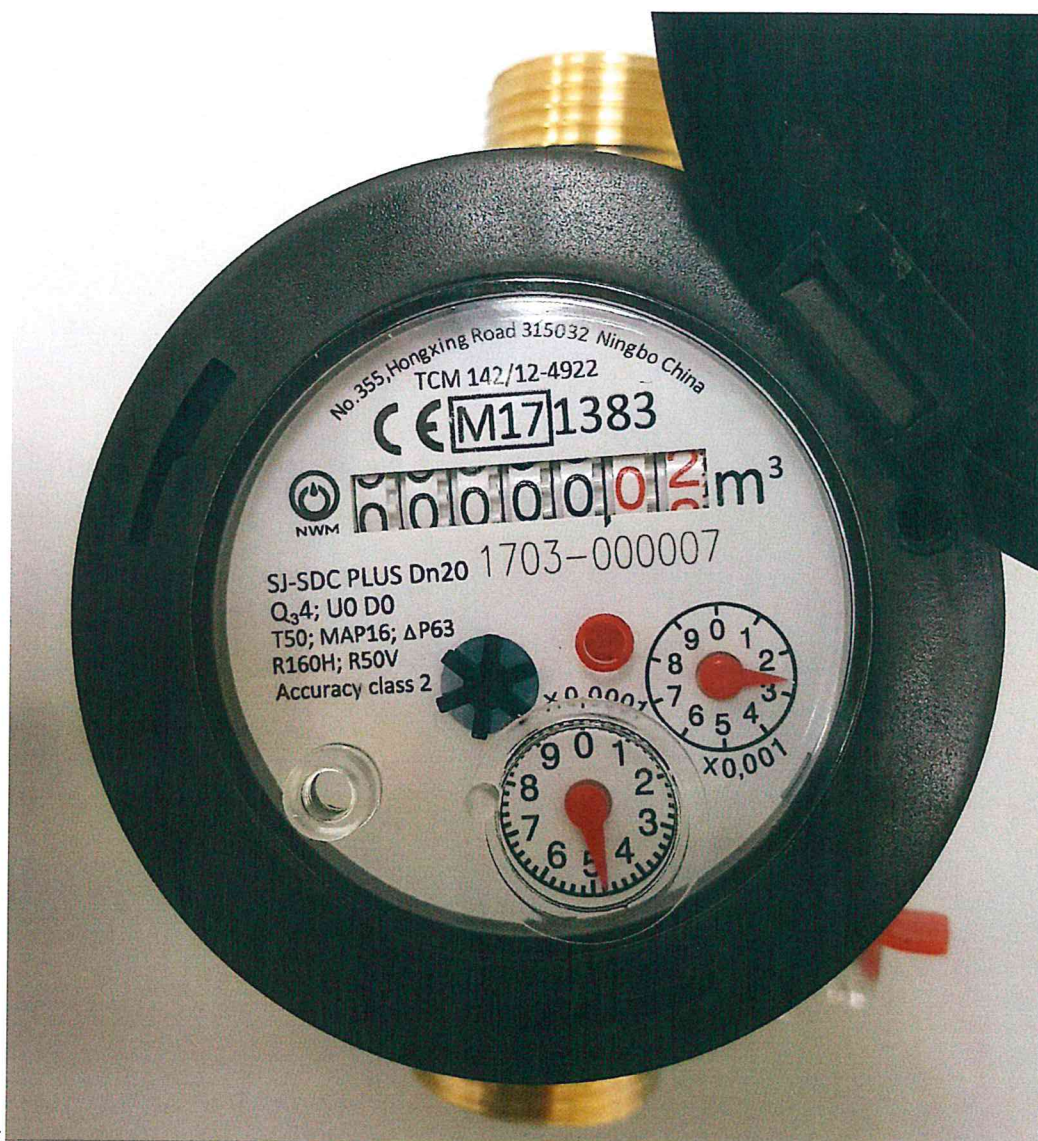
Fotografía 2.- Muestra del medidor de agua marca NWM, modelo SJ-SDC PLUS, DN20 J. 0011507, 02 tambores, 02 punteros circulares y con un pin de seguridad entre la luneta y la plaqueta del registro
